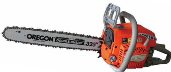
Fiable, para los que necesitan un trabajo rápido y preciso, equipada con tensor de cadena lateral y filtro de aire tipo cartucho de papel.
