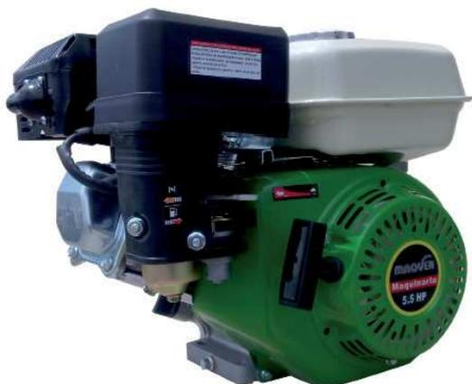
Disponemos de varios tipos de cigüeñal para adaptar a generadores, motoazadas, motobombas, etc. Motor estacionario de 168FA 5.5 HP, con sistema OHV (válvulas a la cabeza), de eje horizontal con arranque manual y alerta de aceite que hace detener el equipo en caso de bajo nivel de aceite.
